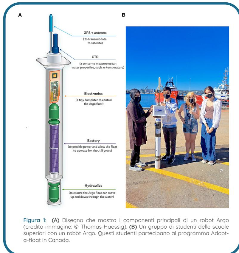
**Figura 1:** (A) Disegno che mostra i componenti principali di un robot Argo (credito immagine: © Thomas Haessig). (B) Un gruppo di studenti delle scuole superiori con un robot Argo. Questi studenti partecipano al programma Adopt-a-float in Canada.
